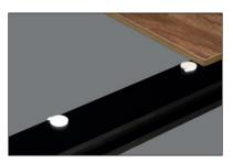
**4.** Setzen Sie die **Fixier- und Montagepads** entsprechend dem Plattenformat auf den Untergrund.
