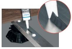
5. Anschließend sollte der Kleber mit der Kartuschenpresse aufgebracht werden. Dank der serienmäßigen V-Düse ergibt sich eine Klebewulst, welche genügend Spielraum bietet, um Toleranzen des Bodenbelags auszugleichen.
